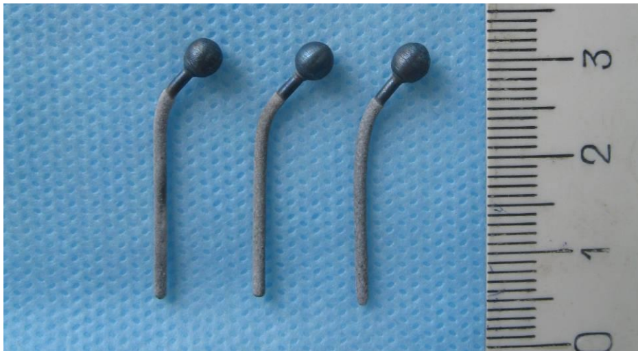
Рис. 2.7. Зовнішній вигляд титанових імплантатів із покриттям ніжки шаром корундової кераміки для проведення алокомпозитного ендопротезування у експерименті у щурів.
