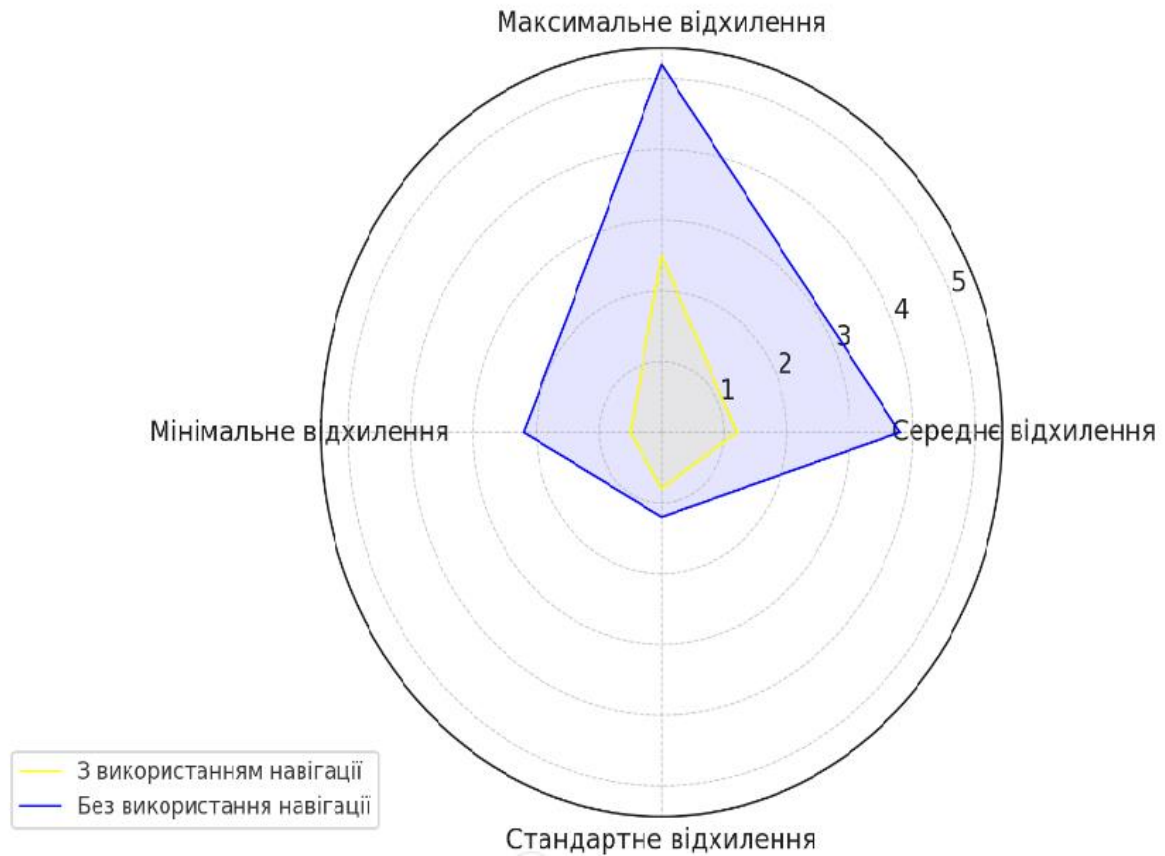
Рис. 4.7. Пелюсткова діаграма: візуально представляє порівняння середнього відхилення, максимального відхилення, мінімального відхилення та стандартного відхилення між використанням навігації (жовтий) і без використання навігації (синій) при симуляційному ендопротезуванні кльшового суглоба.
