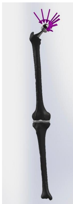
Рис 3.1. 3D модель нижньої кінцівки з ендопротезом кульшового суглоба та дією на нього сили навантаження
