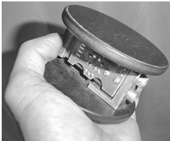
Рис. 1.6. Фото. Мануальний м'язовий тестер на базі датчика механічного зусилля
