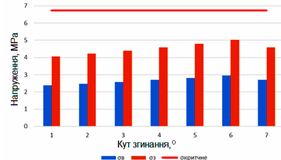
Рис. 3.6. Діаграма напружень на контактних поверхнях плато великогомілкової кістки при пасивному згинанні на 6^\circ
