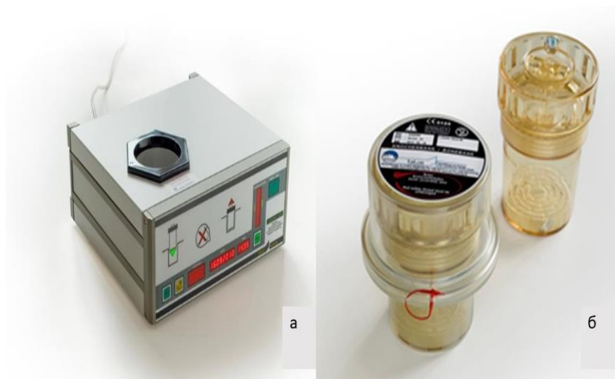
Рисунок 2.5 – Система для термостерилізації алогенних головок стегнових кісток від живих донорів: а – Lobator, б – стерилізаційний контейнер
