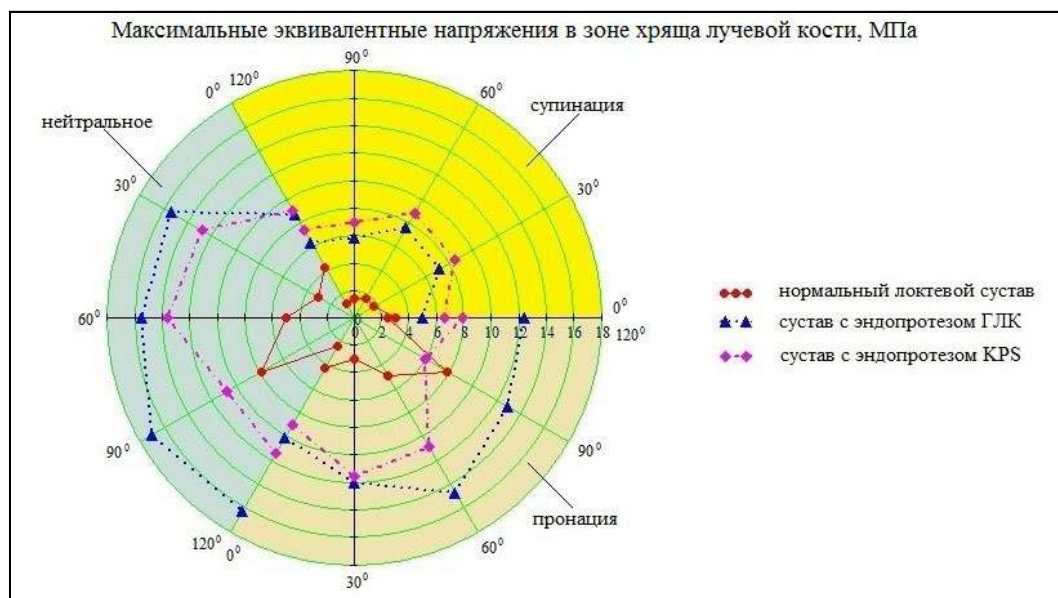
рис. 3.29. Поля максимальних напружень в зоні контакту хряща променевої кістки для різних положень передпліччя.
