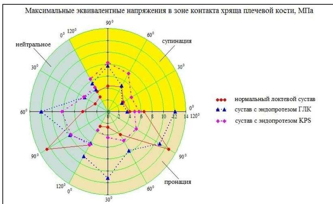
рис 3.30. Поля максимальных напряжений у зоні контакту хряща плечової кістки для різних положень передпліччя.
