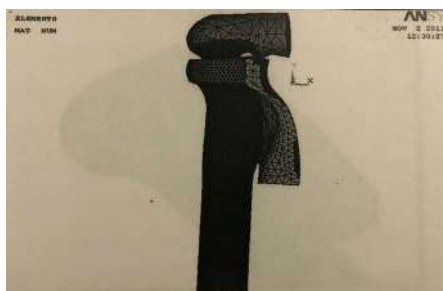
рис. 3.2. Кінцево - елементна сітка досліджуваної моделі променеліктового й променеплевого суглобів.
