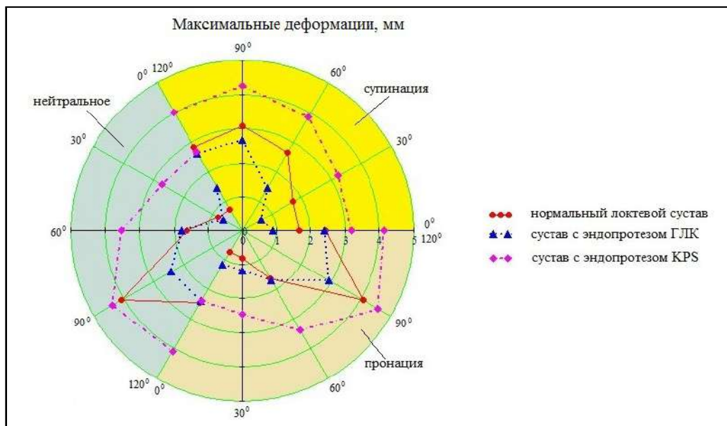
рис. 3.28. Поля максимальних деформацій для різних положень передпліччя.
