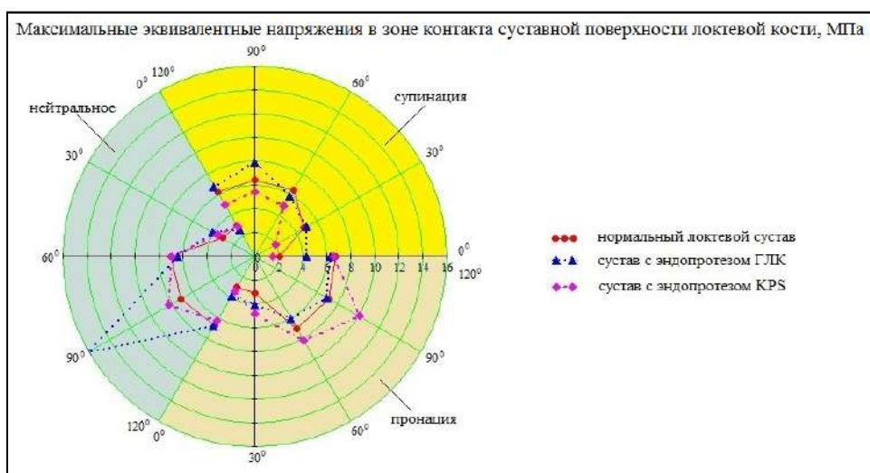
рис. 3.31. Поля максимальних напружень у зоні контакту суглобової поверхні ліктьової кістки для різних положень передпліччя.
