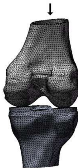
Рис. 3.4. Кінцево-елементна модель кінематичного ланцюга.
