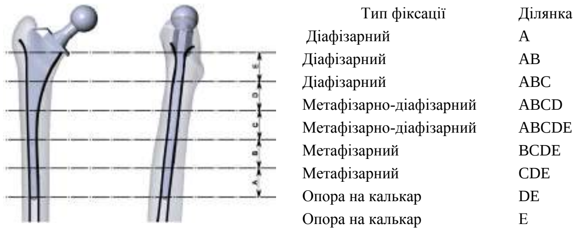
Рис. 3.41 Варіанти фіксації безцементної ніжки стандартного ендопротеза залежно від форми кістково-мозкового каналу
