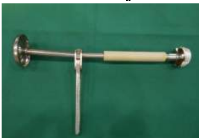
Рис. 4.17. Інструментарій для встановлення АК, що загвинчується: а – рукоятка-направлювач у зборі з чашкою, б – інструмент у робочому стані; в – різновиди утримувачів АК, що загвинчуються
