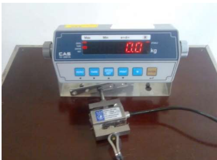
Рис.34 Пристрій реєстрації CAS типу CI-2001A з тензOMETричним датчиком SBA-100L.
