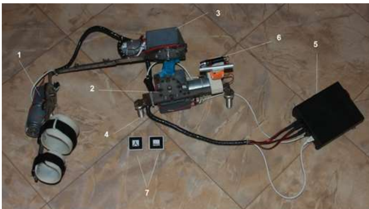
Рис. 5.6. Комп'ютерно-апаратний комплекс: 1 – мотор вісі ротації; 2 – мотор вісі відведення; 3 – мотор вісі згинання; 4 – кріплення до операційного столу; 5 – керуючий блок; 6 – лазерний моторизований вказівник; 7 – металізовані маркери.
