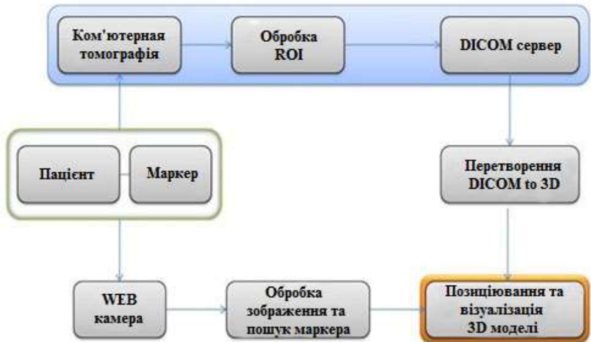
Рис. 5.9. Блок-схема роботи системи інтраопераційної візуалізації на базі доповненої реальності
