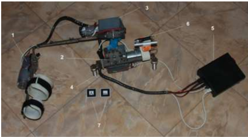
Рис. 5. Комп'ютерно-апаратний комплекс: 1 – мотор вісі ротації; 2 – мотор вісі відведення; 3 – мотор вісі згинання; 4 – кріплення до операційного столу; 5 – керуючий блок; 6 – лазерний моторизований вказівник; 7 – металізовані маркери.
